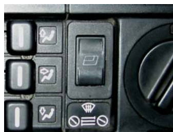
Schalter neben der Lüftungssteuerung Druck oben = Betätigung Fahrertür Druck unten = Betätigung Beifahrertür Nicht möglich in Verbindung mit einer Hardtopvorbereitung.
